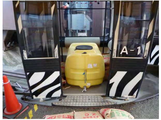
<制動試験ウェイト積み込み状態>
